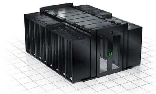
La arquitectura es la de armarios Racks en dos hileras, formando entre ellas un **pasillo caliente**. El sistema de climatización se encarga de tomar el aire caliente del pasillo, para enfriarlo y volverlo a impulsar al ambiente de la sala, para que lo reciban los equipamientos TI.
